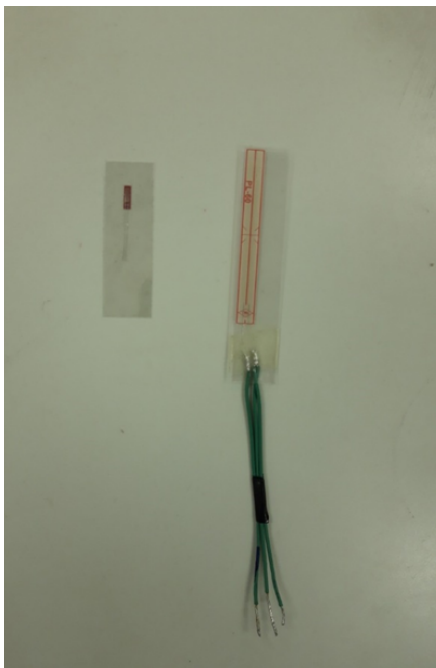
(a) Cảm biến điện trở đo kết cấu thép (nhỏ), Cảm biến điện trở đo kết cấu bê tông (lớn)
