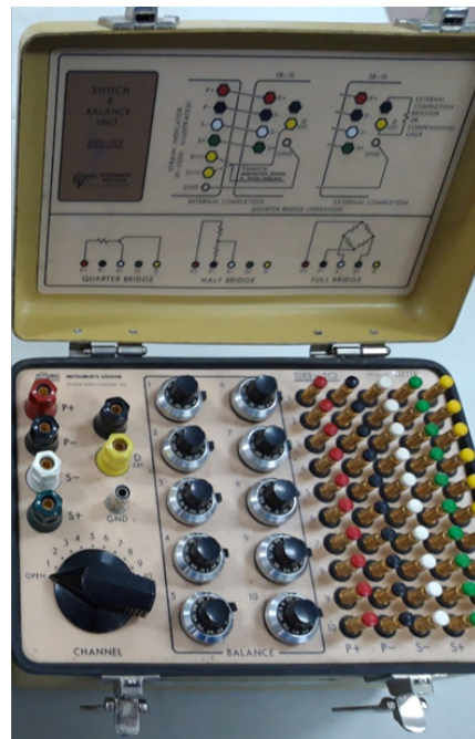
(b) Bộ thu và xử lý dữ liệu từ cảm biến điện trở
