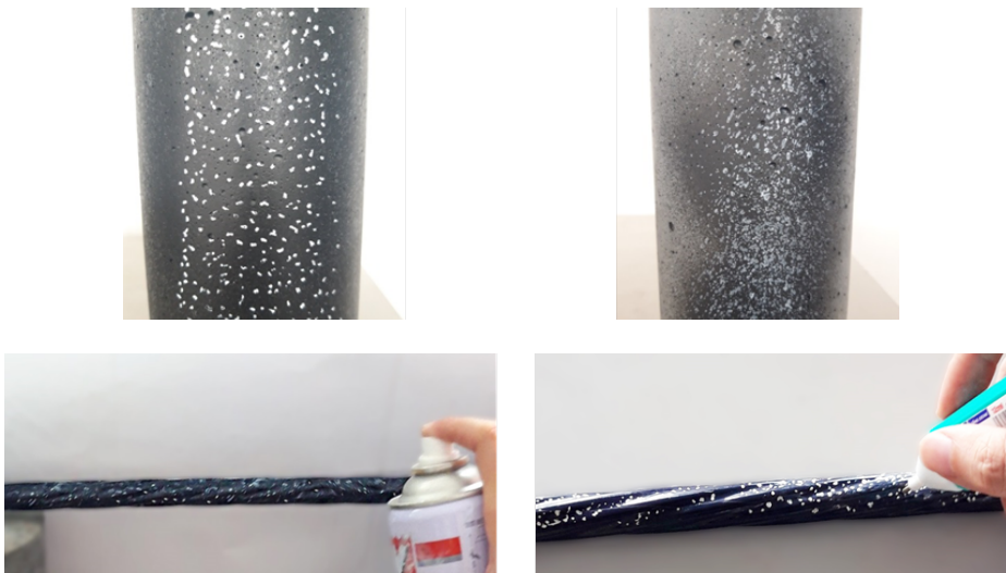
Hình 4. Hình thức tạo mô hình đốm chấm sử dụng chấm bút phủ và phun sơn
