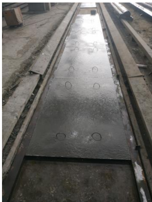
Hình 12. Sản xuất đại trà tấm ván khuôn UHPC cho cầu An Thượng
