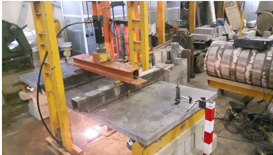
(a) Lắp đặt hệ gia tải và bố trí thiết bị thí nghiệm tấm bản mỏng UHPC
