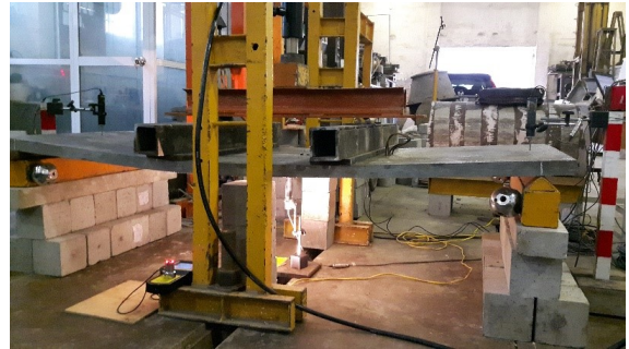
(b) Thí nghiệm thử tải tấm bản mỏng UHPC
